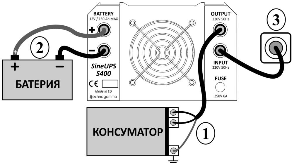
1. Свържете консуматора към кабелите от извод *OUTPUT*. Захранващите кабели (кафяв и син) се свързват към консуматора, а зануляващия проводник (жълто-зелен) се свързва само в случай, че консуматорът има специален занулятелен извод.
